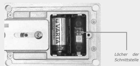
*Achtung: Für die optimale Datenübertragung die Pins nur bis zur Hälfte in die fünf Löcher der Schnittstelle stecken (oberhalb des weißen Tasters).*
