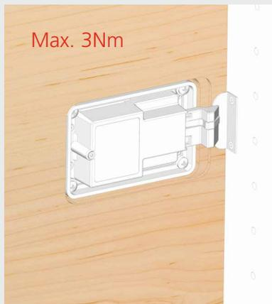
Drücken Sie das Schloss gegen die Tür und drehen Sie die Schrauben in die dafür vorgesehenen Löcher im Rahmen und ziehen Sie diese handfest. Max. 3Nm.
