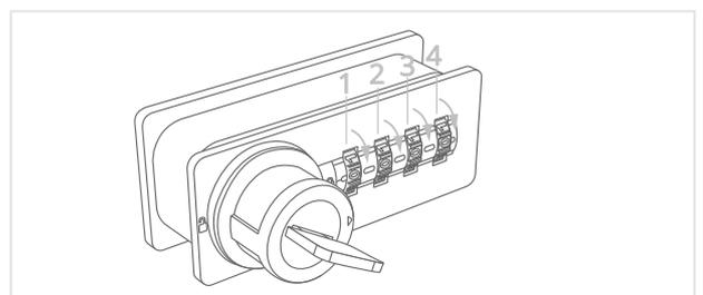
6. Knauf in die geöffnete Position (Pfeil zeigt auf das grüne Schlosssymbol) drehen und Tür aufziehen. Den Masterkey abziehen. Zum Schließen den Schritt **1** unter dem Punkt „Bedienung“ befolgen.
