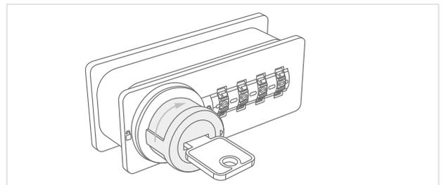
4. Knauf festhalten. Masterkey gegen den Uhrzeigersinn so weit drehen, bis er nicht mehr bewegt werden kann. **Knauf und Masterkey in dieser Position halten.**
