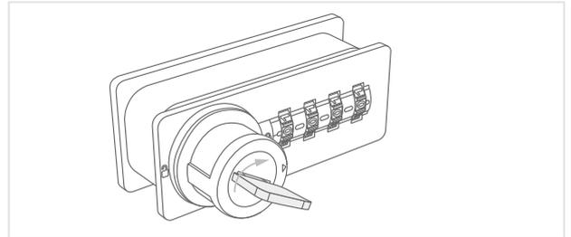
3. Knauf mit dem Uhrzeigersinn so weit drehen, bis er nicht mehr bewegt werden kann.
