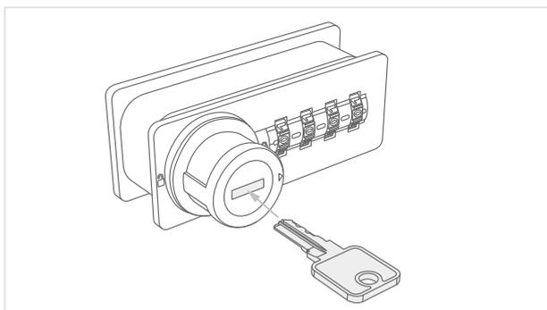
2. Knauf festhalten. Masterkey mit dem Uhrzeigersinn so weit wie möglich drehen.
