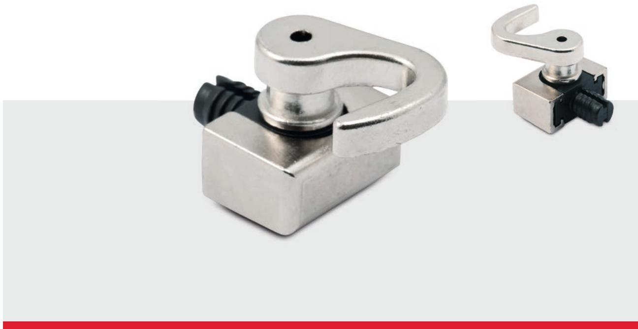
**Produktbeschreibung:** Schließhaken zum Dübeln für 6/5 mm Drehstangen. Für die Montage rechts unten oder links oben. Zamakgehäuse mit Kunststoff-Lager.
