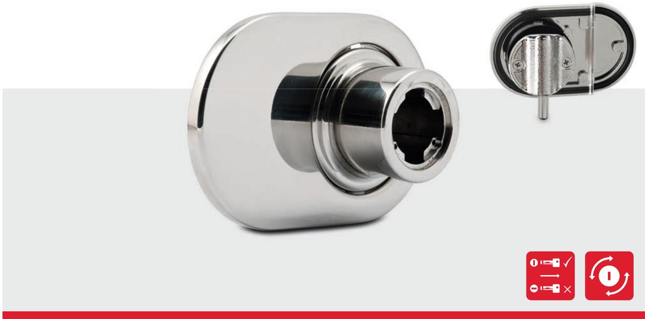
**Produktbeschreibung:** Knopfzylinder für Glasflügelür (doppelseitig) mit Anschlagplatte, ohne Zylinderkern. Einsetzbar in 6 mm und 8 mm starke Glastüren.
