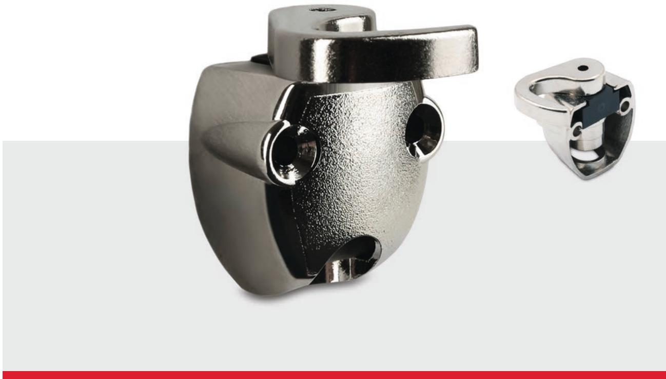
**Produktbeschreibung:** Schließhaken zum Aufschrauben für 6/5 und 8/7 mm Drehstangen. Für die Montage links unten oder rechts oben. Zamakgehäuse mit Kunststoff-Lager.
