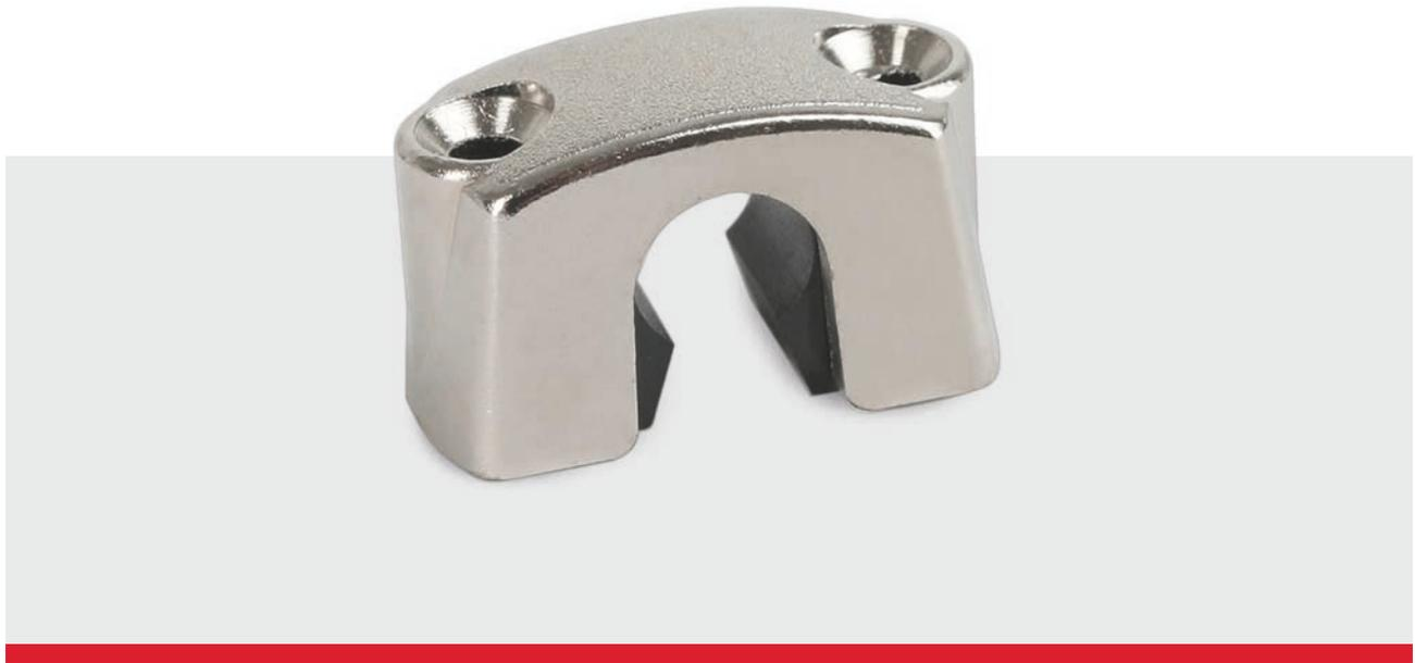
**Produktbeschreibung:** Zwischenführung zum Aufschrauben für 8/7 mm Drehstangen. Zamakgehäuse mit Kunststoff-Lager.
