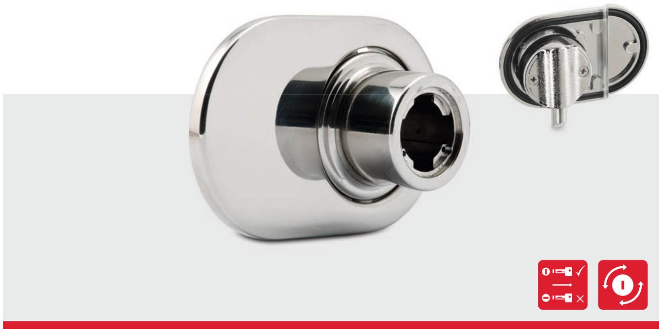
**Produktbeschreibung:** Knopfzylinder für Glasflügeltür (doppelseitig) mit gefedertem Fallenriegel, ohne Zylinderkern. Einsetzbar in 6 mm und 8 mm starke Glastüren.
