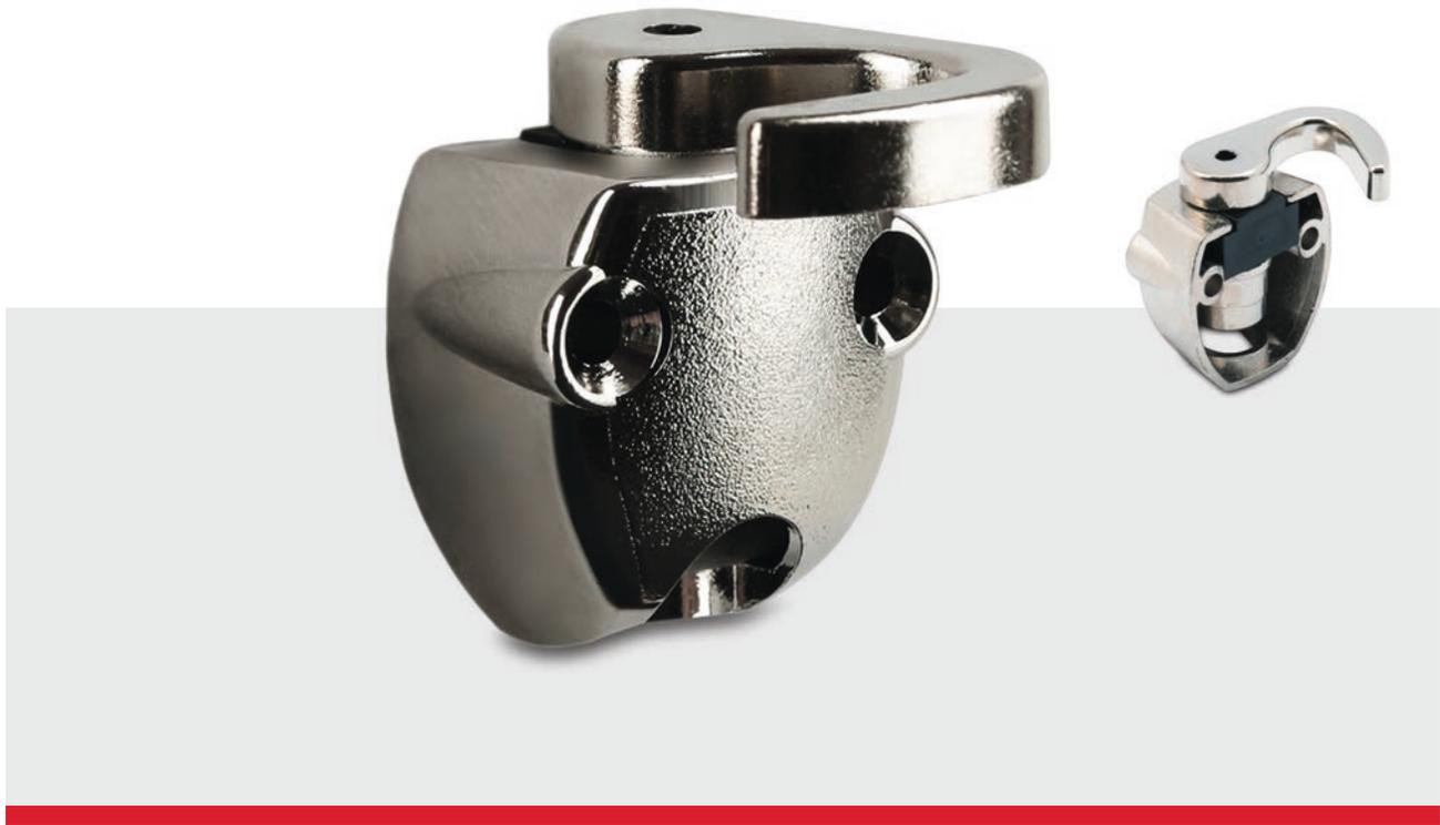
**Produktbeschreibung:** Schließhaken zum Aufschrauben für 6/5 und 8/7 mm Drehstangen. Für die Montage rechts unten oder links oben. Zamakgehäuse mit Kunststoff-Lager.
