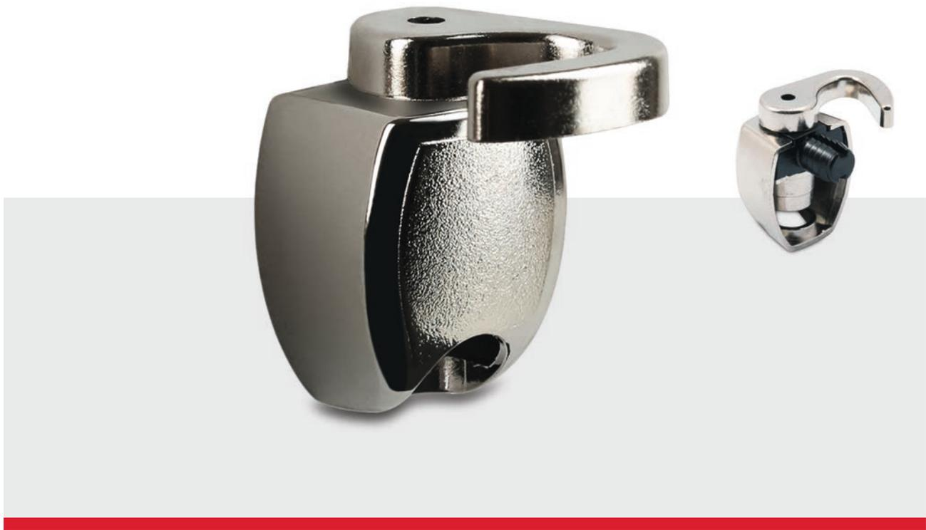
**Produktbeschreibung:** Schließhaken zum Dübeln für 6/5 und 8/7 mm Drehstangen. Für die Montage rechts unten oder links oben. Zamakgehäuse mit Kunststoff-Lager.
